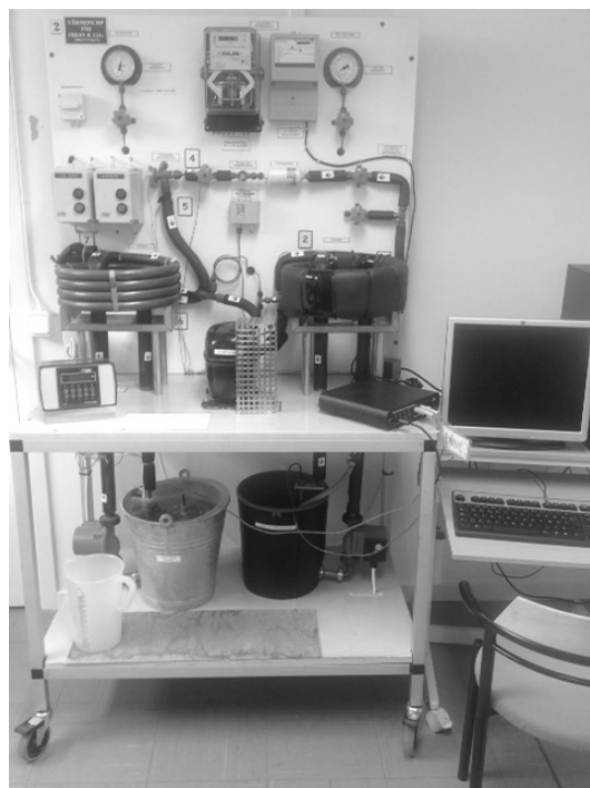
Figur 7. Laborationens värmepumpsanläggning med inkopplat mätsystem.
